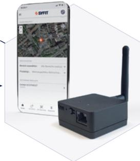
Die Übermittlung der Geo-Koordinaten an die Applikation erfolgt über Smartphones oder BLE-Gateways mit Verbindung über WLAN, Power-over-Ethernet (PoE) oder einer LTE-M Karte.
